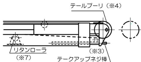
**D リタンローラによる調整** (→側面図 ② および P.21 平面図 ④ ① 参照)
